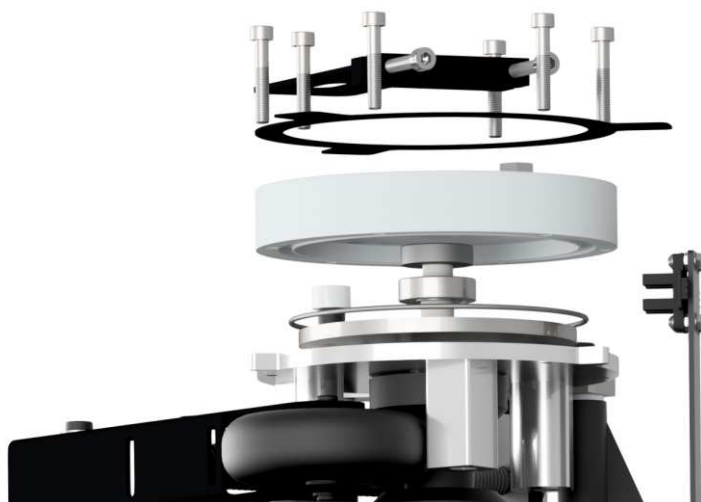
Рисунок 28 – Порядок замены сальника
