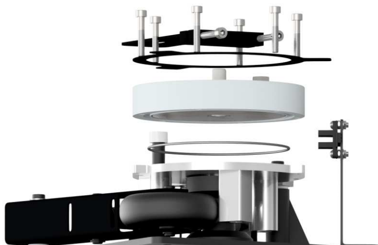
Рисунок 27 – Порядок замены уплотнительного кольца
