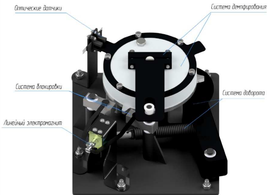
Рисунок 4 – Устройство механизма турникета
