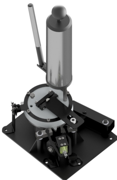
Рисунок 29 – Доливка демпферной жидкости
